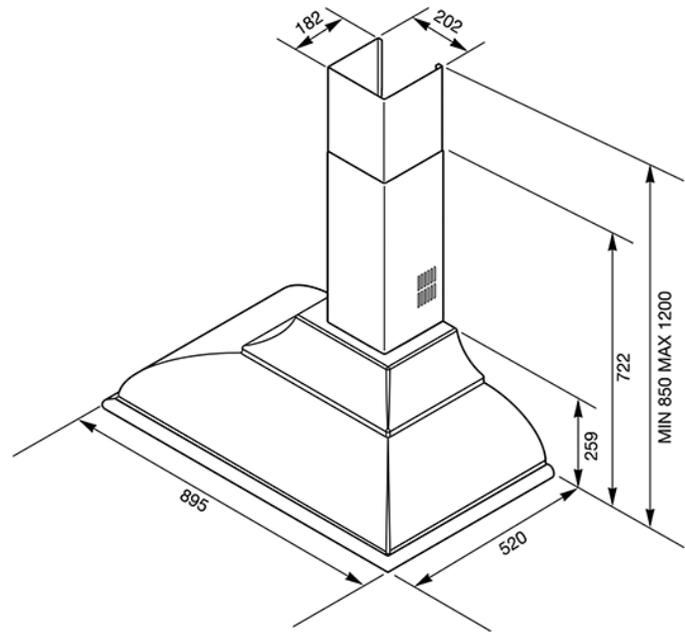
• Gehäuse im Thermoplast-Style in Creme • Untere Reling + SMEG-Logo im Messing Creme-Design • Bedienung über Knebel • 3 Leistungsstufen + INTENSIV • 2 LED-Beleuchtungen (2x 1 W) • 3 Aluminiumfettfilter • Teleskopkamin in Creme • Abluftanschluss Ø 150 mm mit Luftrückschlagklappe • Abluft-/ Umluftbetrieb • TECHNISCHE DATEN: • Durchschnittlicher Energieverbrauch: 58 kWh/Jahr • Energie-Effizienzklasse: A • Lüfter-Effizienzklasse: A • Beleuchtungs-Effizienzklasse: A • Fettfilter-Effizienzklasse: C •
