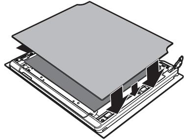
4. Die äußere Glasscheibe und die zuvor ausgebauten Glasscheiben reinigen. Saugfähiges Küchenpapier verwenden. Hartnäckiger Schmutz kann mit einem feuchten Schwamm und einem neutralen Reiniger entfernt werden.
