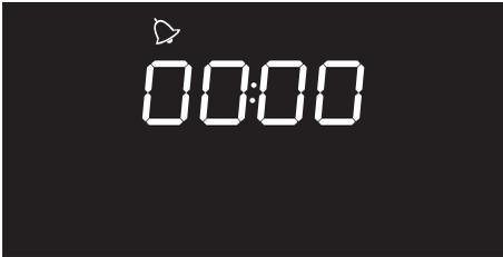
2. Zum Einstellen der Dauer den Drehknebel drehen (von 1 Minute bis 4 Stunden). Nach einigen Sekunden hört die Kontrolllampe
