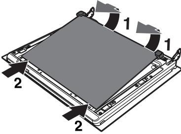
5. Die Glasscheiben in umgekehrter Reihenfolge im Vergleich zum Ausbau wieder einsetzen.
