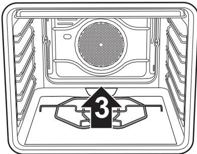
3. Um den Sockel der Pizzaplatte wieder einzusetzen, muss man ihn bis zum Anschlag an die Rückseite des Backraums schieben und so absinken lassen, dass die Platte des Heizelements in den Sockel einrastet.
