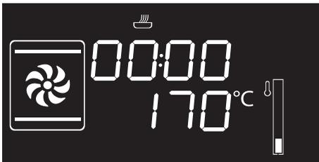
2. Den Drehknebel nach rechts oder links drehen, um die Gardauer von 00:01 bis 12:59 einzustellen. Den Drehknebel gedreht halten, um eine schnellere Werterhöhung bzw. -verminderung zu erzielen.
