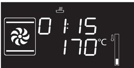
3. Den Zeit-/Temperaturknebel ein viertes Mal drücken. Die Kontrolllampe
