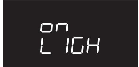
Um zu verhindern, dass das Gerät die Lampe eine Minute nach Garbeginn automatisch ausschaltet, muss dieser Modus auf OFF gestellt werden.
