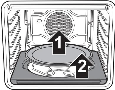
2. Das Ende des unteren Heizelements (3) einige Zentimeter anheben und den Backraumboden reinigen.
