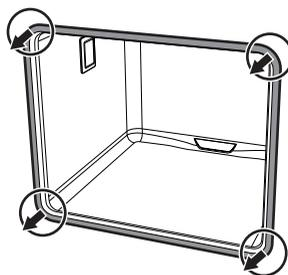
Einsetzen der Ofendichtung:
