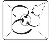
Der Garraum wird mit Heißluft beheizt. Zugegebene Dampfschwaden sorgen dafür, dass die Energie effizienter auf das Gargut übertragen wird. Der Garprozess wird dadurch leicht beschleunigt und das Gargut wird besonders knusprig.
