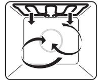
Die Beheizung erfolgt durch den Grillheizkörper. Die Garraumluft wird durch das Heißluft-
