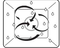
Die Garraumluft wird durch den Heizkörper hinter der Garraumrückwand aufgeheizt und gleichmäßig umgewälzt. Die entstehende Eigenfeuchtigkeit wird minimal aus dem Garraum abgeführt. Die Feuchtigkeit des Garguts bleibt erhalten.
