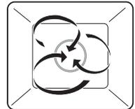
Die Garraumluft wird durch den Heizkörper hinter der Garraumrückwand aufgeheizt und gleichmäßig umgewälzt. Durch die zeitlich gesteuerte Türöffnung wird die aus dem Gargut tretende Feuchtigkeit in regelmäßigen Abständen großzügig abgeführt. Das Gargut trocknet langsam aus.
