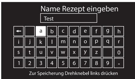
13. Den Namen des Rezeptes eingeben. Den Bedienknebel so lange drehen, bis der einzugebende Buchstabe ausgewählt ist. Mit jeder Betätigung des Bedienknebels wird ein Buchstabe des Namens eingegeben. Das Zeichen
