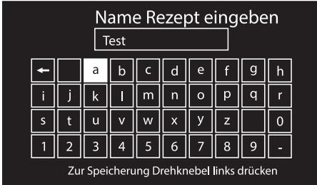
13. Den Namen des Rezeptes eingeben. Den Bedienknopf so lange drehen, bis der einzugebende Buchstabe ausgewählt ist. Mit jeder Betätigung des Bedienknopfs wird ein Buchstabe des Namens eingegeben. Das Zeichen
