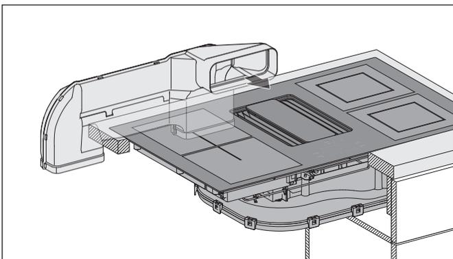
☞ Stecken Sie den Umluftbogen in den Anschluss am Lüftergehäuse.
