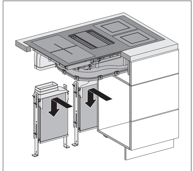
☞ Richten Sie die Umluftfilter mit der Klappvorrichtung zur Zugangsseite aus. Beachten Sie dabei die Kennzeichnung auf dem Gerät.
