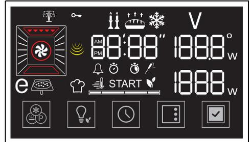
Das Display zeigt die Parameter und Werte des ausgewählten Vorgangs an. Um die Automatik zu nutzen, die Funktions- und Temperaturnebel drehen oder die Taste im unteren Teil des Displays betätigen, je nach den Funktionen, die das Gerät durchführen soll.
