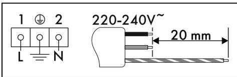
Dreipoliges Kabel 3 x 1,5 mm<sup>2</sup>.
