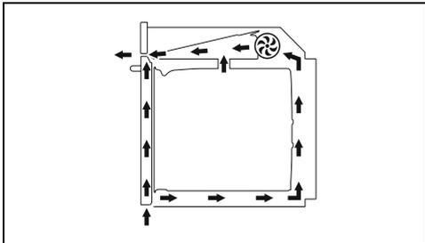
Der Lüfter kühlt das Gerät ab und setzt sich während des Garvorgangs in Betrieb. Der Lüfterbetrieb erzeugt einen normalen Luftstrom, der über der Tür austritt und über einen kurzen Zeitraum auch nach dem Ausschalten des Gerätes andauern kann.
