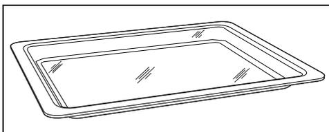
Für jede Art von Garvorgang und zum Auffangen des Fetts von Speisen, die sich auf dem darüber liegenden Rost befinden. Auf dem abgesenkten Grill eignet es sich besonders für das Garen in der Mikrowelle.
