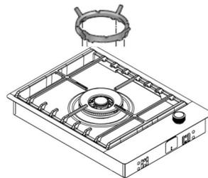
Falls auf dem Wokbrenner Töpfe mit einem Durchmesser über 26 cm verwendet werden sollen, benutzen Sie bitte den mitgelieferten Wok-Adapter in der umgekehrten Ausrichtung wie im linken Bild gezeigt (die längeren Finger nach unten). Im anderen Fall kann es zu Schäden an der Metalloberfläche des Kochfelds kommen.
