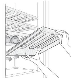
Die Tablare sind nicht Höhenverstellbar. Zur Reinigung können sie entfernt werden.
