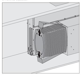
B Lösen Sie die Halteklammer vom Umluftfilter.
