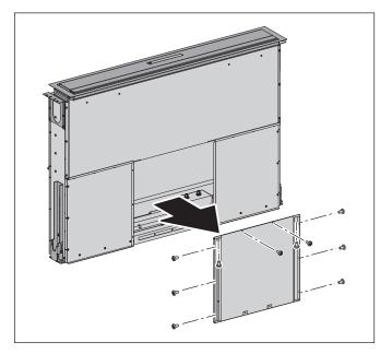
Lösen Sie die Schrauben der mittleren Korpusblende auf der Seite ohne Lüfterkasten.
