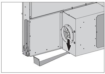
Fixieren Sie die untere Halteklammer am Lüftergehäuse.
