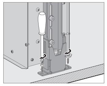
Fixieren Sie die Stützfüße auf beiden Seiten am Boden.
