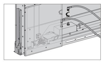
Lösen Sie die Anschlüsse vom Lüfterkasten im Haubenkorpus.
