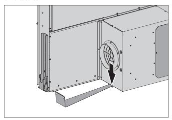
Fixieren Sie die untere Halteklammer am Lüftergehäuse.
