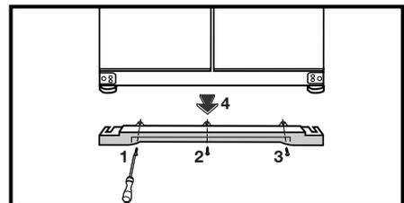
3. Drehen Sie die Schrauben an der unteren Belüftungsöffnungabdeckung mit einem Kreuzkopfschraubendreher heraus.
