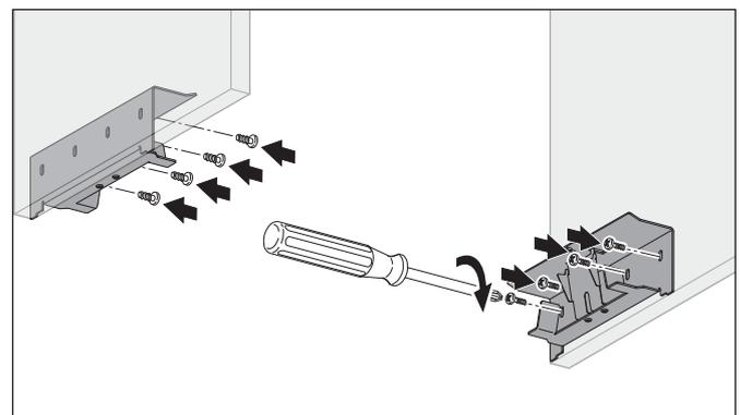
☞ Schrauben Sie die Befestigungshalter an den Schrank (Spanlattenschrauben PZ2 4,5 x 16 mm).
