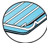
**Stellen Sie sicher**, dass der Kippschutzrand nach außen zeigt, wenn Sie die Kombination Glastropfschale und Grillrost in den Ofen schieben.
