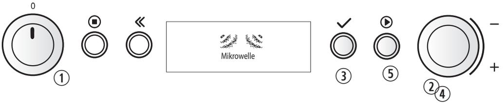
1. Den Multifunktionsknopf drehen, bis „Mikrowelle“ angezeigt wird.
