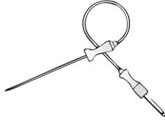
**Sicherstellen**, dass die Speisesonde so weit wie möglich in der Speise steckt. Dies gewährleistet präzisere Temperaturmessungen.
