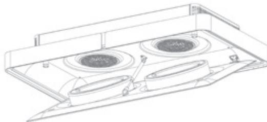
Open de onderplaat door deze aan de voorzijde met 2 handen naar beneden te trekken.
