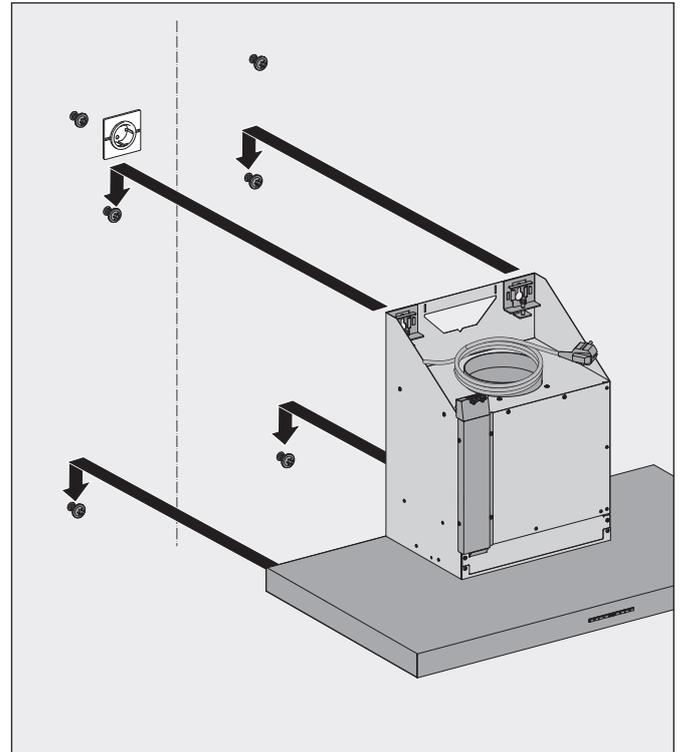
Die oberen Befestigungsschrauben werden erst nach Ausrichtung des Geräts festgezogen.
