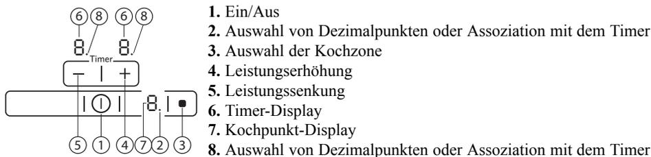
Das elektronisch gesteuerte Touch-Control Bedienfeld wird mit der Ein/Aus-Taste aktiviert und vom Aus-Modus in den Standby-Modus geschaltet.
