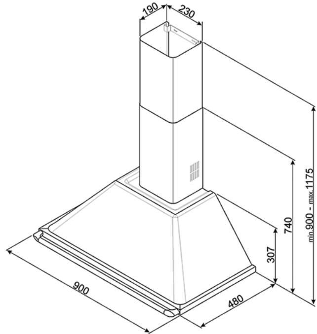
• Bedienung über Drehknebel • Gehäuse lackiert in Creme • Verzierungen im satiniertem Edelstahl-Design • 3 Leistungsstufen + INTENSIV • 2 LED-Beleuchtungen (2x 2 W) • 3 Aluminium-Fettfilter • Teleskopkamin • Abluftanschluss Ø 150 mm mit Lufrückschlagklappe • Abluft-/ Umluftbetrieb • TECHNISCHE DATEN: • Durchschnittlicher Energieverbrauch: 59,4 kWh/Jahr • Energie-Effizienzklasse: A • Lüfter-Effizienzklasse: A • Beleuchtungs-Effizienzklasse: A • Fettfilter-Effizienzklasse: C •
