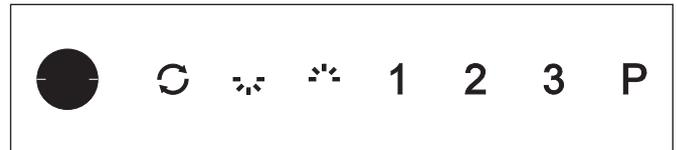
Die Position des Bedienfelds ist an der Mulde der EIN/AUS-Taste jederzeit zu erkennen. Die übrigen Tastfelder leuchten, wenn das Gerät eingeschaltet ist.
