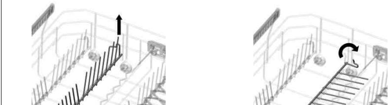
Ablaufhilfen, dank denen die Teller besser trocknen. Sie sind schon im Korb angebracht oder befinden sich im Zubehörbeutel; im letztgenannten Fall muss man sie einfach in die hierfür vorgesehenen Aufnahmen einsetzen, wie es in der Abbildung dargestellt ist.
