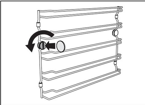
2. Den Rahmen vorsichtig zum Inneren des Garraums ziehen, so dass er sich aus der Einrastvorrichtung A löst.
