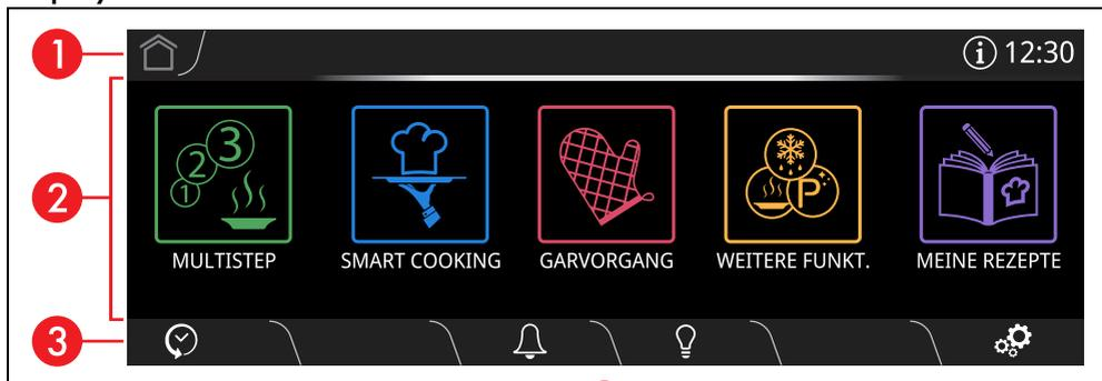
Das Display zeigt die Parameter und Werte des ausgewählten Vorgangs an. Die Bedienung erfolgt einfach durch Berührung der „virtuellen“ Tasten und/oder Durchlaufen der angezeigten Werte (die Abbildung zeigt den Bildschirm mit dem Hauptmenü).
