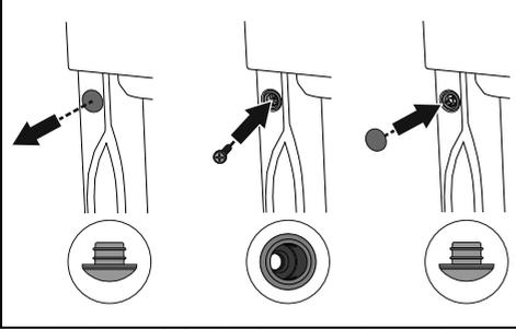
1. Die Stöpsel der Buchsen an der Vorderseite des Gerätes entfernen.
