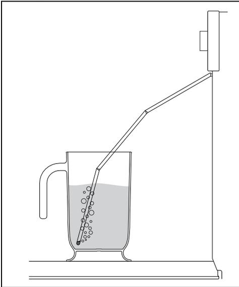
6. Die Taste Start
