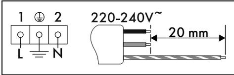
Dreipoliges Kabel 3 x 1,5 mm<sup>2</sup>.
