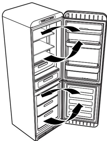
Das interne Belüftungssystem ermöglicht eine schnelle Kühlung der Speisen und sorgt für eine homogene Kühlung im Schrank.
