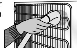
Kontrollieren Sie regelmäßig auch die Schale über dem Kompressor, und reinigen Sie sie falls erforderlich.
