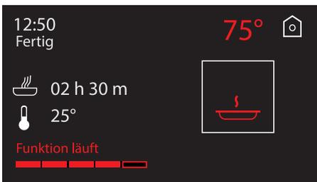
8. Am Ende der Funktion löst das Gerät ein akustisches Signal aus, die Fortschrittsleiste der Funktion und die Temperatur werden nicht mehr angezeigt.
