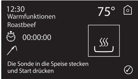
8. Die Temperatursonde muss tief in die Mitte der Speise eingesteckt werden, ohne diese vollständig durchzustechen.
