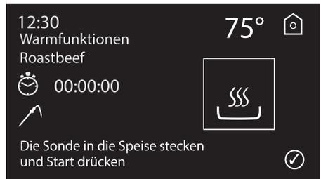
10. Nach Aktivierung der Funktion erscheint die folgende Bildschirmseite. Die Bildschirmseite bleibt aktiv, solange die neben dem Symbol der Sonde angezeigte Temperatur (25 °C) nicht mit der Temperatur über dem Symbol der Funktion, die für jedes Lebensmittel unterschiedlich ist, übereinstimmt.
