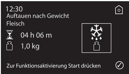
5. Nach erfolgtem Funktionsstart zeigt die Bildschirmseite die bis zum Ende der Funktion noch verbleibende Zeit an.
