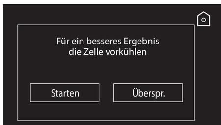
6. Nach der Bestätigung zeigt das Display an, dass die Vorkühlung der Zelle läuft.
