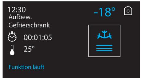
5. Bei Erreichen der Temperatur löst das Gerät ein akustisches Signal aus.
