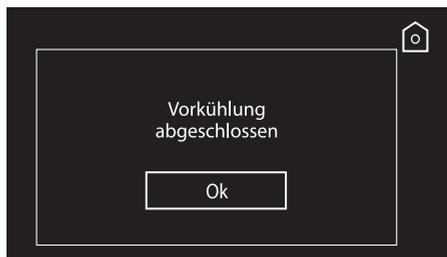
**i** Es empfiehlt sich, eine Vorkühlung der Zelle durchzuführen, um bessere Ergebnisse zu erzielen. Die für die Vorkühlung empfohlene Temperatur beträgt  $-30\text{ }^{\circ}\text{C}$ . Die Vorkühlung muss bei leerer Zelle, ohne die Eingabe von Lebensmitteln, erfolgen.
