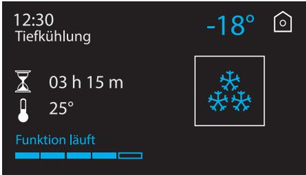
9. Sobald die Temperatur von -18 °C erreicht ist, löst das Gerät ein akustisches Signal aus, die Fortschrittsleiste der Funktion und die Temperatur werden nicht mehr angezeigt.
