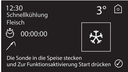
9. Nach Aktivierung der Funktion erscheint die folgende Bildschirmseite. Die Bildschirmseite bleibt aktiv, solange die neben dem Symbol des Thermometers angezeigte Temperatur (25 °C) nicht mit der Temperatur über dem Symbol der Funktion (3 °C) übereinstimmt.
