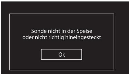
14. „Ok“ drücken und die Sonde einfügen. Wenn die Sonde nicht eingeführt wurde oder als nicht ordnungsgemäß eingefügt angesehen wird, wird folgende Bildschirmseite angezeigt:
