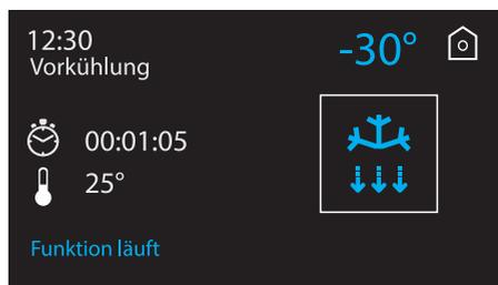
6. Nach Erreichen der eingestellten Temperatur löst das Gerät ein akustisches Signal aus, die Fortschrittsleiste der Funktion und die zu erreichende Temperatur werden nicht mehr angezeigt.
