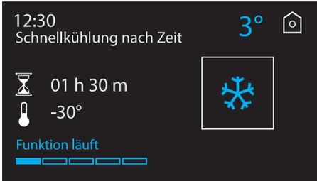
10. Am Ende der Funktion löst das Gerät ein akustisches Signal aus, die Fortschrittsleiste der Funktion und die zu erreichende Temperatur werden nicht mehr angezeigt.
