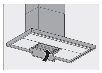
Schwenken Sie die Unterschale nach oben bis die beiden Haltemagnete hörbar anliegen.
