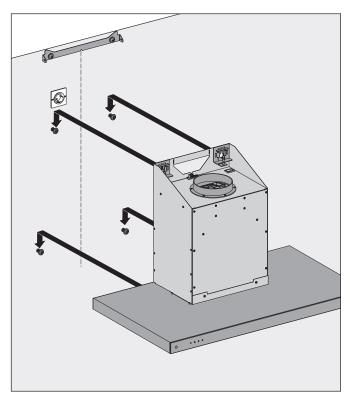
Hängen Sie das Gerät an den Befestigungspunkten auf.
